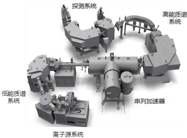
图 2-1 AMS 系统组成示意图
